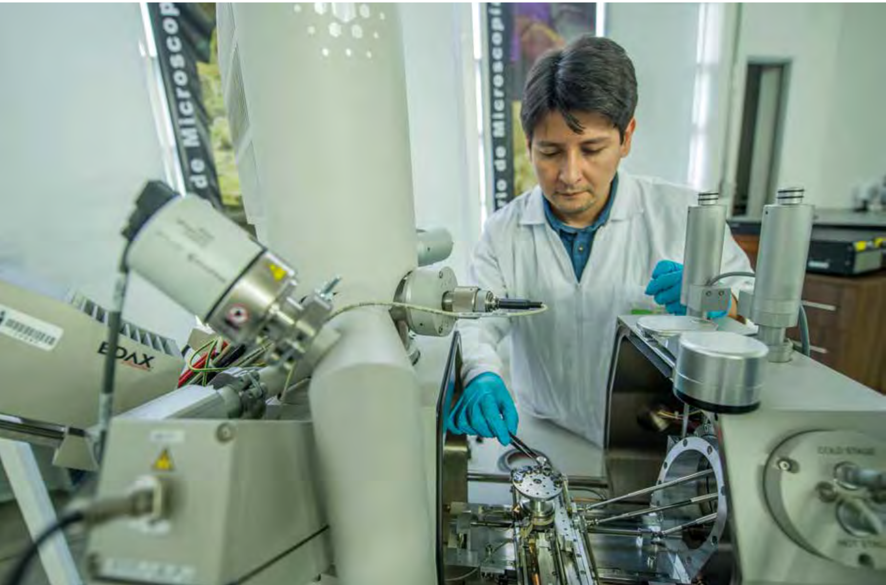
Figura 14. Microscopio electrónico del Parque Tecnológico de Guatiguará de la UIS (Piedecuesta), usado en el estudio de minerales y demás muestras geológicas
